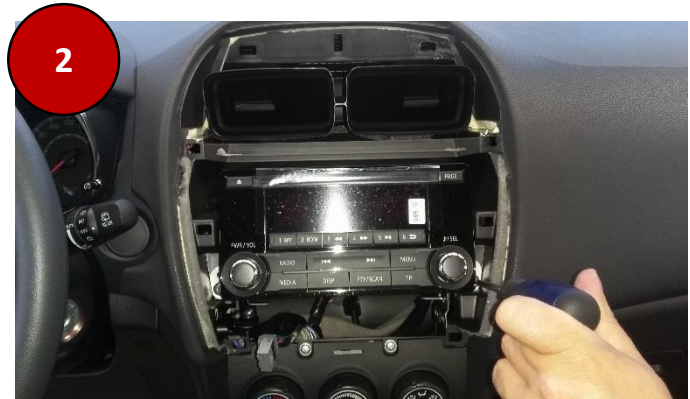
Rimuovere le 4 viti di fissaggio dell' autoradio
