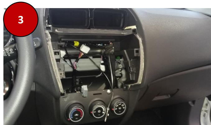
Rimuovere i connettori radio, quindi asportare la stessa dalla sede
